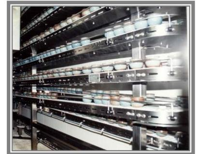
Bild 4: VA-Speicher Im Kühlraum bei -20°C
