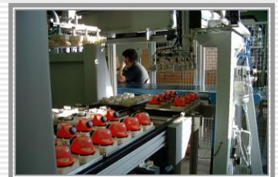
Bild 7: Automatische Entnahme der Teile mit Handlingsystem vor Ort
