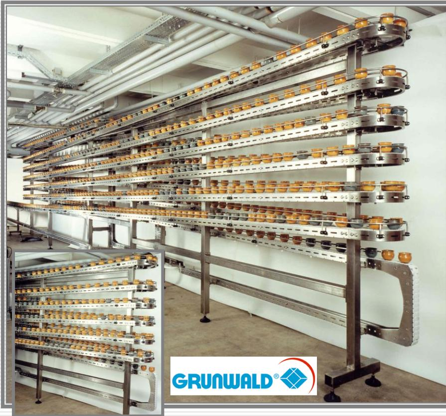
Bild 1: VA-Wendelspeichersystem mit ca. 210m flexibler Förderkette und nur mit 2 Antrieben für den Betrieb von +5° bis -20°C im Kühlraum.
