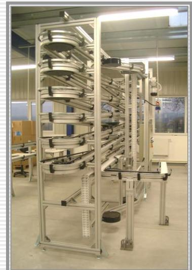
Bild 3: Speichersystem mit Zuführband.
