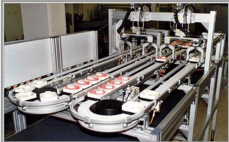
Bild 3: Flexibles Palettensystem mit Greiferwechseleinheiten
