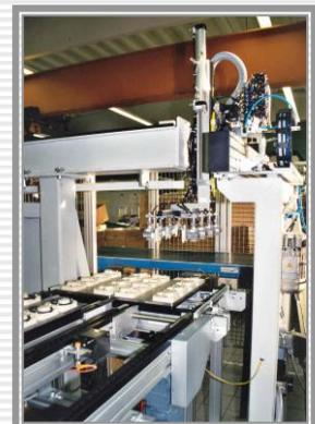
Bild 8: Die Übergabestation der Fertigteile.
