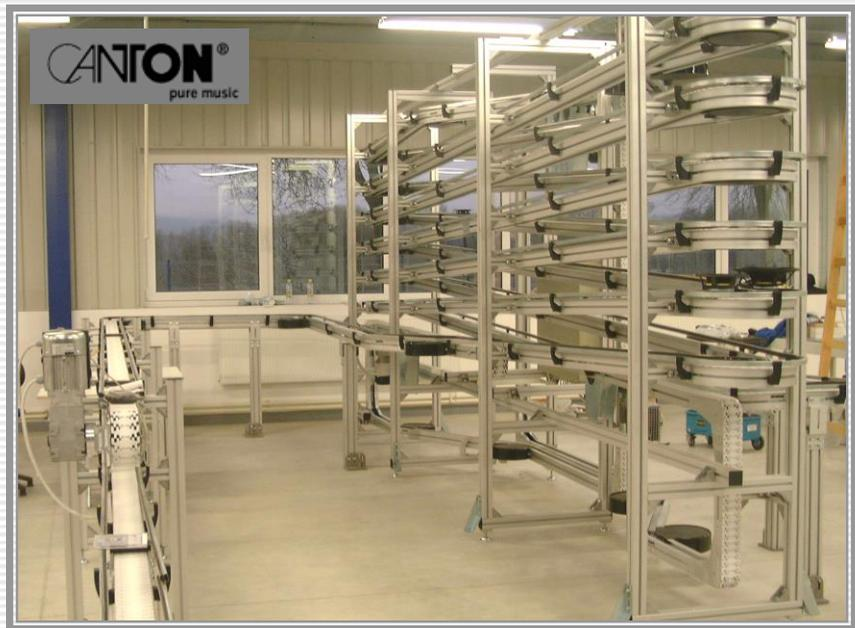
Bild 1: Das Speicherbandsystem VF90 mit obenliegender Kette beim Kunden
