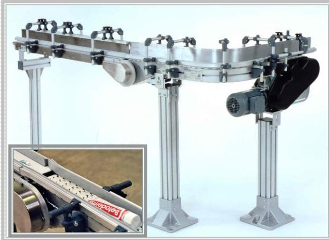
Bild 1: Geteiltes Übertriebsband für Flaschen an der Umlenkung
