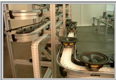
Bild 5: Der Abtransport der Lautsprecher mit VF90 Bändern zu den Arbeitsplätzen.
