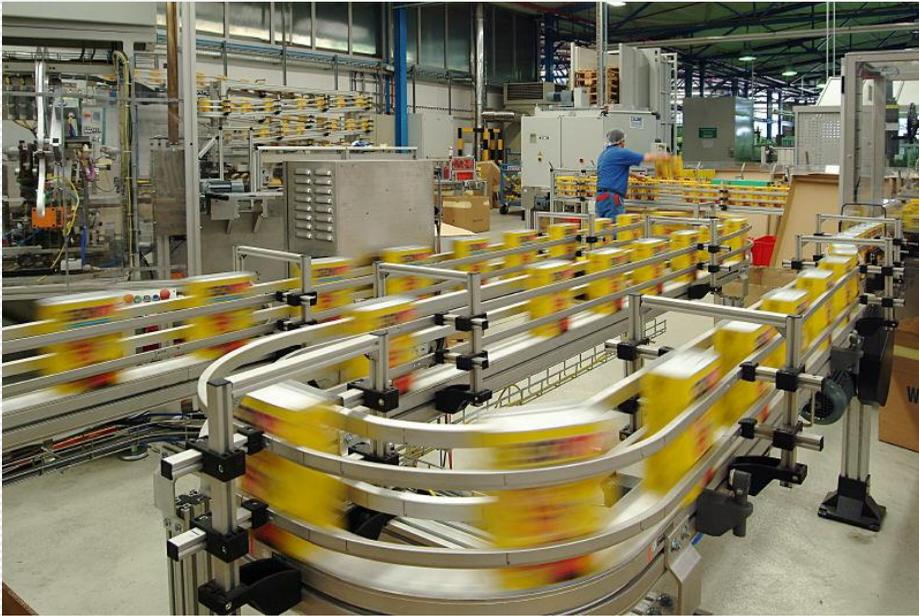
Bild 1: Das Speicherbandsystem mit Pufferstrecke
