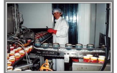
Bild 5: Die Abfüllung bei -5°C
