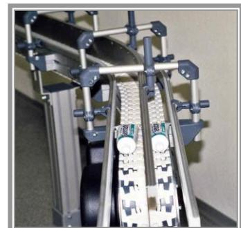
Bild 7: Doppelspurtransport mit Übertriebsband für Tuben
