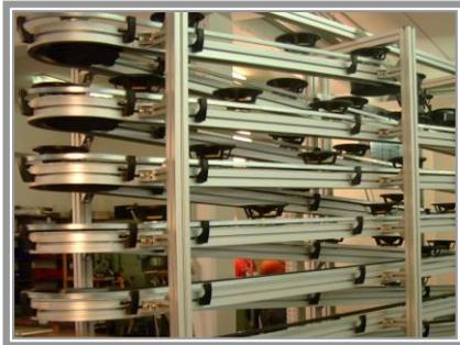
Bild 4: Der Verlauf der Lautsprecher im Speichersystem, 1x kpl. nach Oben und dann kpl. 1x zurück.
