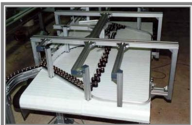
Bild 7 : Verteilertische für Puks, Flaschen und Dosen.
