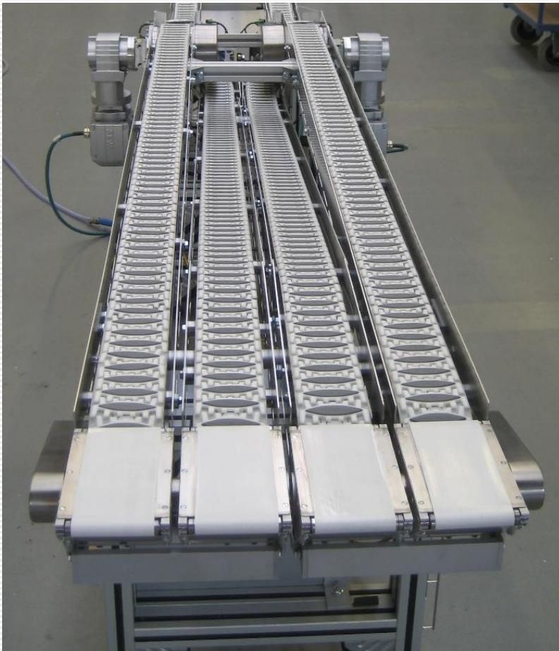
Bild 2: 4-fach Übertrieb mit Verteilung 4 > 2 Stränge
