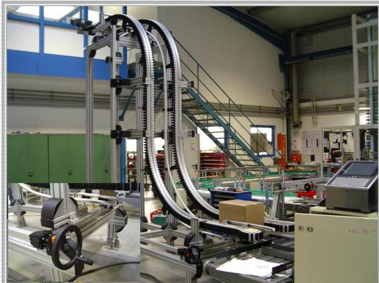
Bild 2: S-Klemmfördersysteme VF80 mit variabler Weitenverstellung
