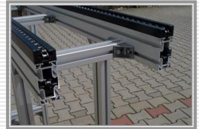
Bild 4: Die Staurollenkette mit dem Tragprofil in den Führungsleisten
