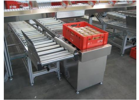
Bild 3: Kistenhubgerät am Befüllplatz
