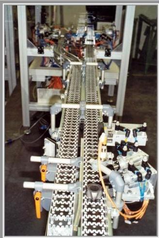
Bild 5: Verkettung mit Stahlkette für Naben mit aut. Dreh-Wendestation
