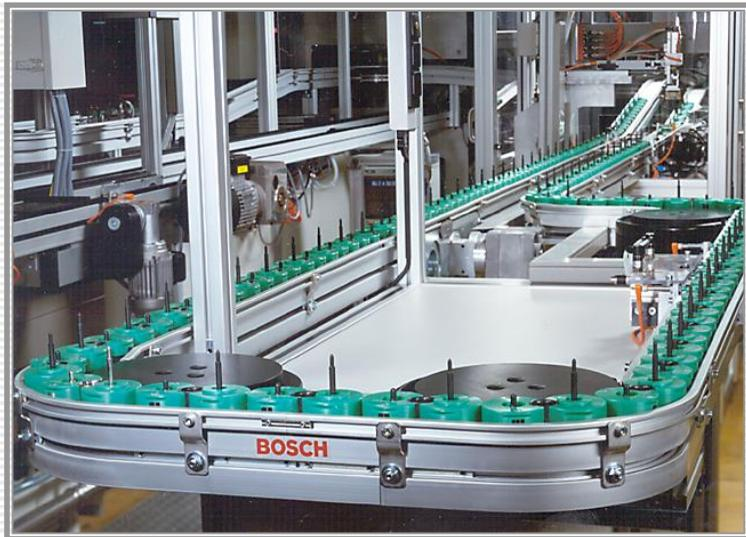
Bild 2: Palettenumlaufsystem für Kleinmotore (Bosch Automotive)
