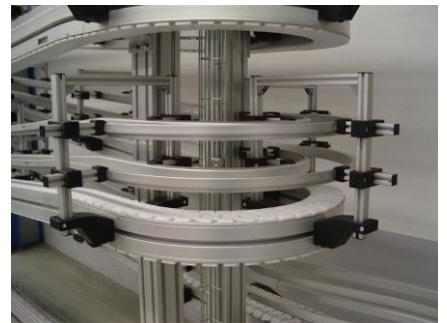
Bild 5: Detail Seitenführung Speicher 1
