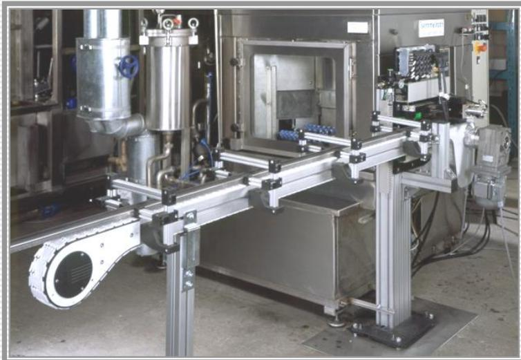
Bild 1: Bandsystem VF 65 als Zuführband in Waschmaschine
