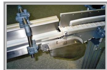
Bild 8: Übergangssituation ca. 15° schwenkbar
