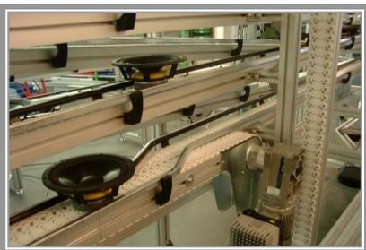
Bild 6: Die Zuführung der Lautsprecher in den Speicher mit Übergang.
