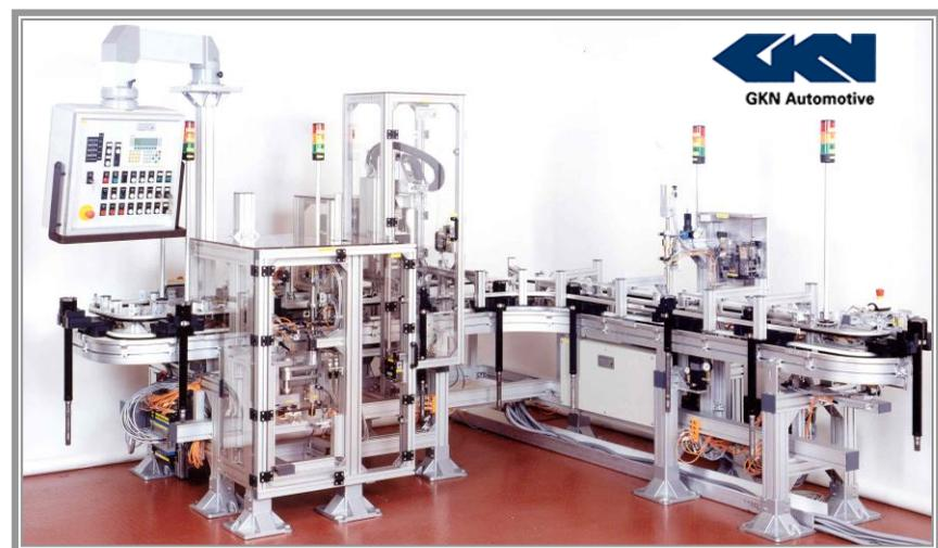
Bild 2: Vollautomatische Montagelinie mit Prüf und Montagestationen
