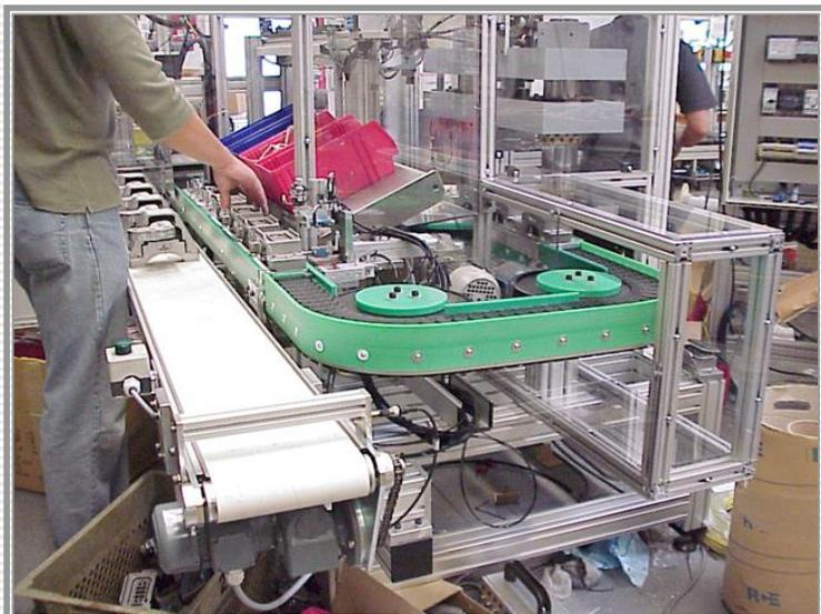
Bild 3: Montage von Bremssteilen mit ESD Kette
