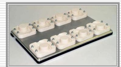
Bild 6: Die Sonderpalette 400x600mm mit je 8 Aufnahmen
