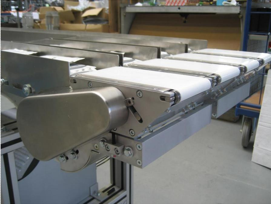
Bild 1: 4-fach Übertrieb mit 2 Antriebseinheiten an den Umlenkungen
