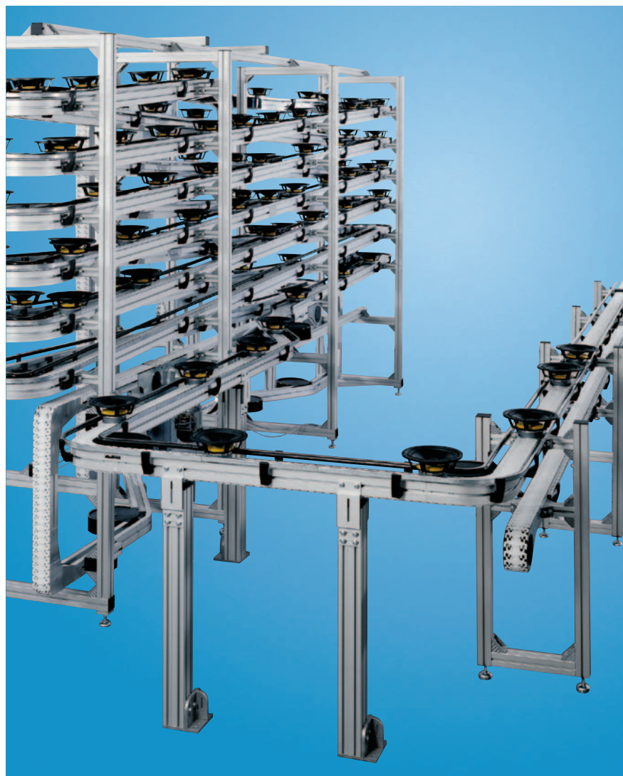
Wendelspeicher zum Trocknen von Lautsprechern Alpine conveyor used to dry loudspeakers Stockage hélicoïdal pour le séchage des haut-parleurs
